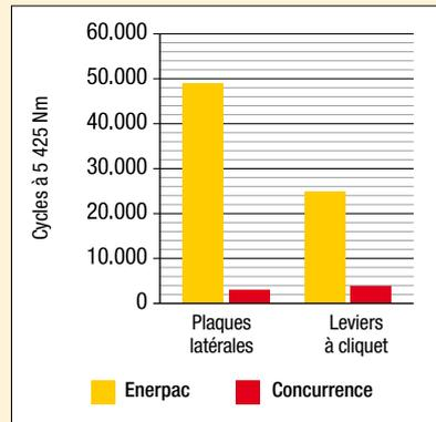
\* Résultats moyens du test réalisé sur trois cassettes UltraSlim Enerpac de 46 mm et trois cassettes de 46 mm de marques concurrentes à 5425 Nm pour 50.000 cycles. Les plaques latérales Enerpac n'ont jamais cédé pendant toute la durée du test.
